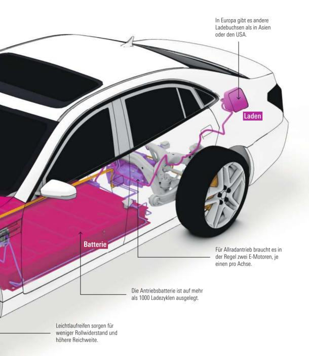
der Anbieter. Die Preise für den schnellen Strom liegen im Bereich von Benzin/ Diesel und damit deutlich über denen von Wallboxen, bei denen Hausstromtarife gelten. Nötig ist dafür eine Vorbereitung des Fahrzeugs mit einer neunpoligen Ladebuchse (CCS Typ 2).
